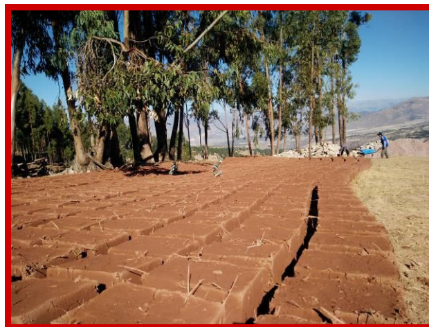
Leemblokken van eigen terrein.
